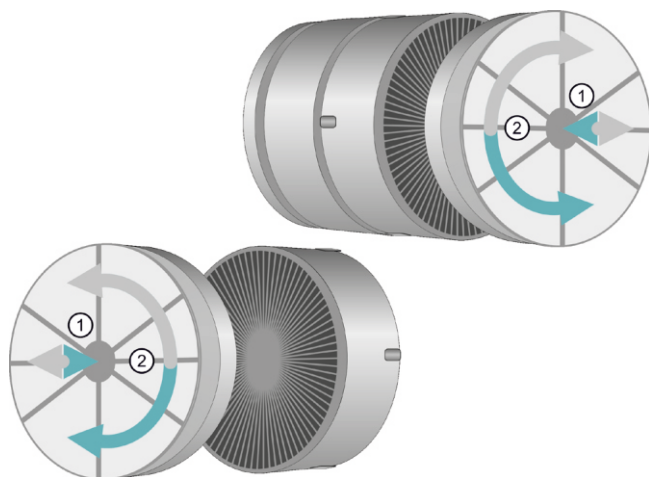
Рис. 14 Установка угольного фильтра
